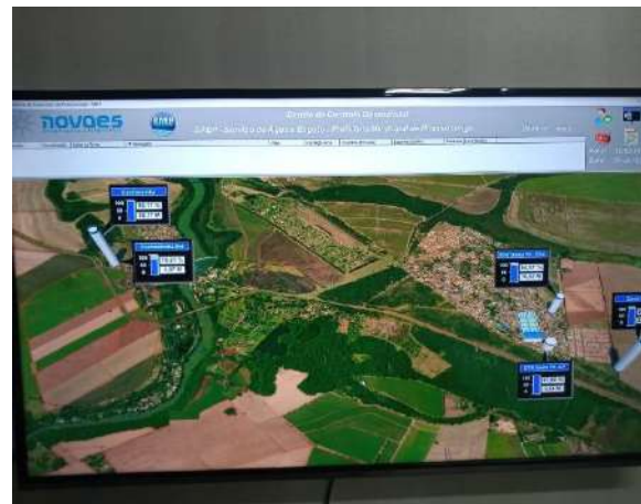
Figura 149 - Painel de controle dos reservatórios Fonte: Amplar Engenharia
