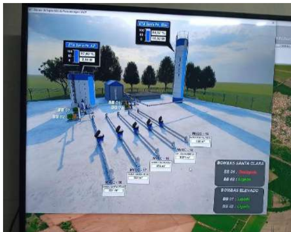
Figura 150 - Painel de controle dos reservatórios Fonte: Amplar Engenharia
